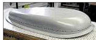
Denne boksen skjuler satellittsenderen og blir montert opp på alle Norwegian-flyene.
